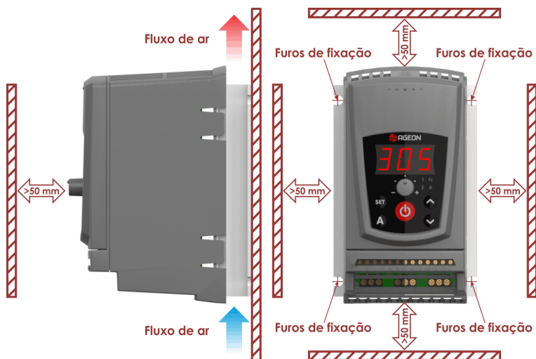
Figura 5-1 - Fixação do inversor
