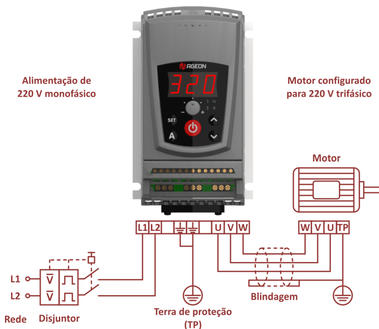
Figura 6-1 - Conexões elétricas de potência
